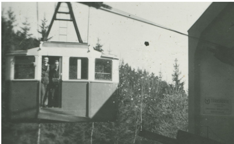
První generace kabiny z roku 1933 v poválečném provozu, zaoblená okna a rovné dno
