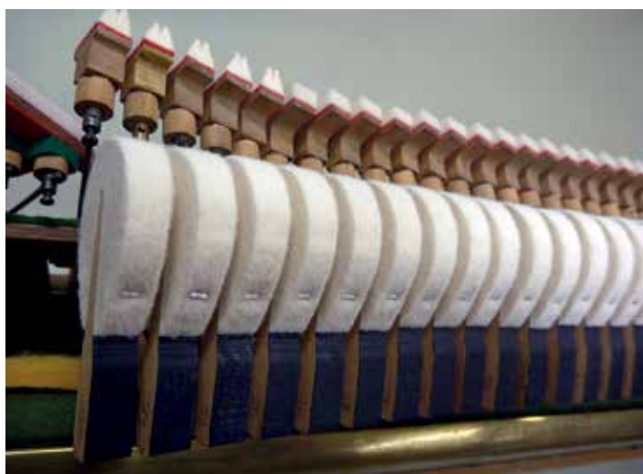
Část pianinové mechaniky z pianoly Philipps, vyrobené okolo roku 1910, před restaurováním a po restaurování
