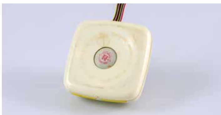
Počítačová myš; autor František Stríž, 1989; kryt je vyroben z krabičky od luxusního toaletního mýdla vyráběného v Rakonu Rakovník; pro snímání pohybu slouží pingpongový míček
