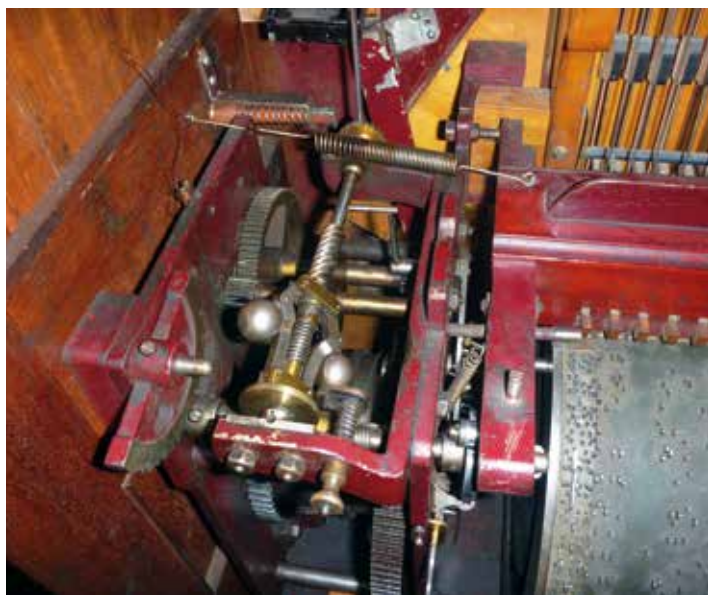
Hnací mechanismus; tempo skladby bylo nastavováno odstředivým regulátorem, jehož opotřebení nebo nesprávná údržba zapříčinila selhávání rozeběhu stroje po vhození mince; to vedlo k různým „hospodským“ návodům, jak pomocí rány nebo kopanců orchestrion uvést do provozu
